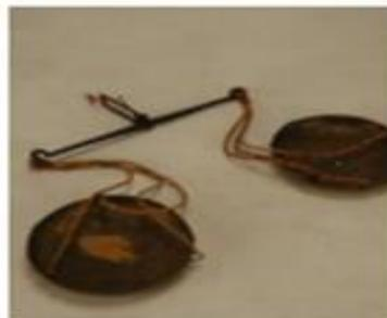
**Legenda:** Haste horizontal, com as extremidades terminadas em forma de orifício, de onde saem os suportes para os pratos da balança. Os pratos são de forma arredondadas com três cavidades onde estão presos os cordões que servem de suporte da haste.
