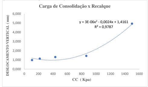
Figura 18 – Relação das médias da carga de consolidação x deslocamento vertical (mm)
