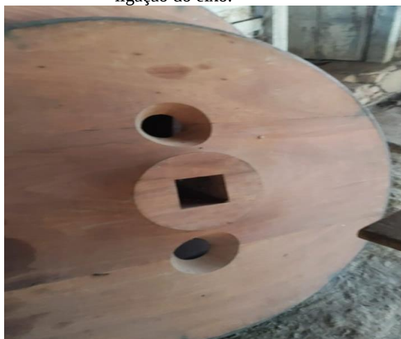
Figura 26 - Formato das duas ocas na roda a posição que ocupa, no centro temos o espaço para fazer a ligação do eixo.
