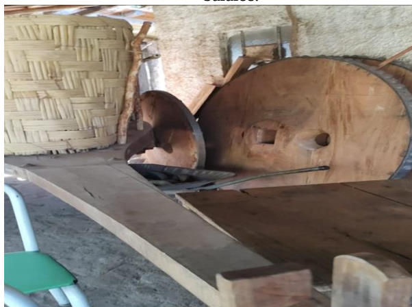
Figura 27 - Rodas para um carro de 40 (quarenta) balaaios ao lado um carro de boi de 20 (vinte) balaaios.
