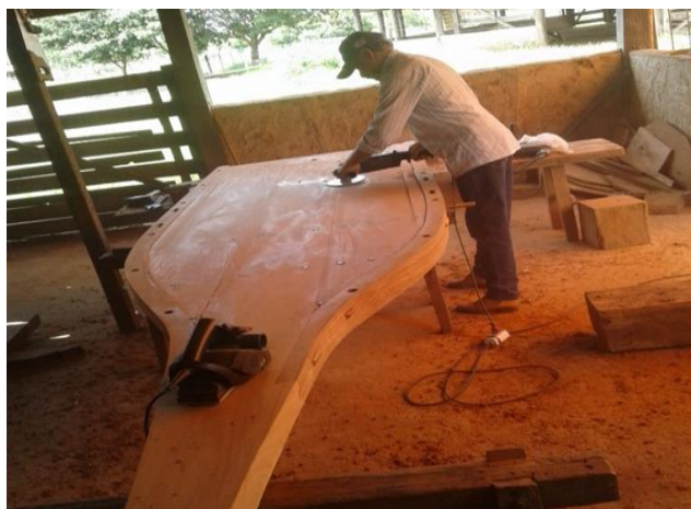
Figura 31 - Fabricação da mesa pelo carapina Sr. Osmiro de Inhumas – GO.
