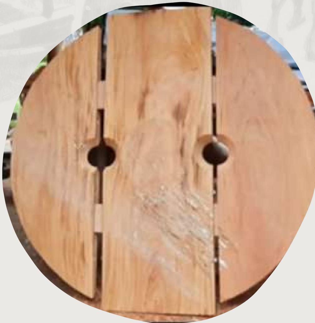
Aqui as três peças já encaixadas dando o formato das rodas com as arreiras encaixadas e o formato das ocas. O próximo passo é realizar simetricamente a união das peças e fazer a fura da mecha, onde se coloca a espiga do eixo.
