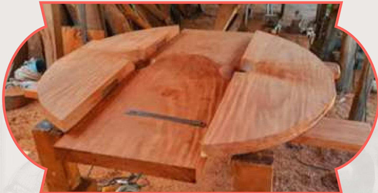
Nesta foto as três peças colocadas juntas já se tem uma noção do formato da roda.
