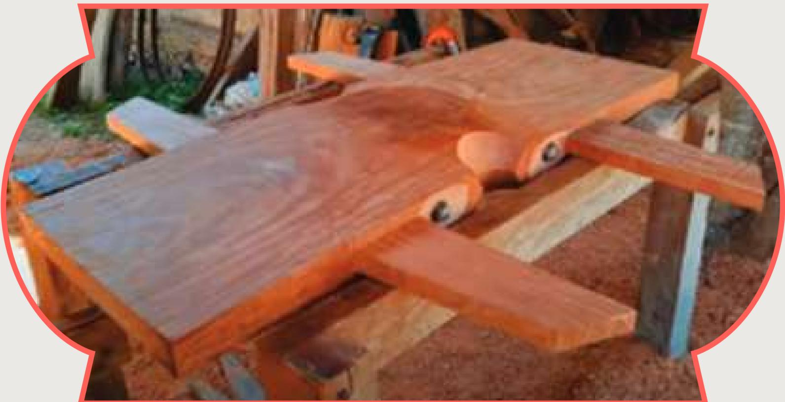
Madeira já cortada em prancha para iniciar a confecção das rodas. São necessárias três pranchas: duas são para as combotas e uma será para o meio (mião).
