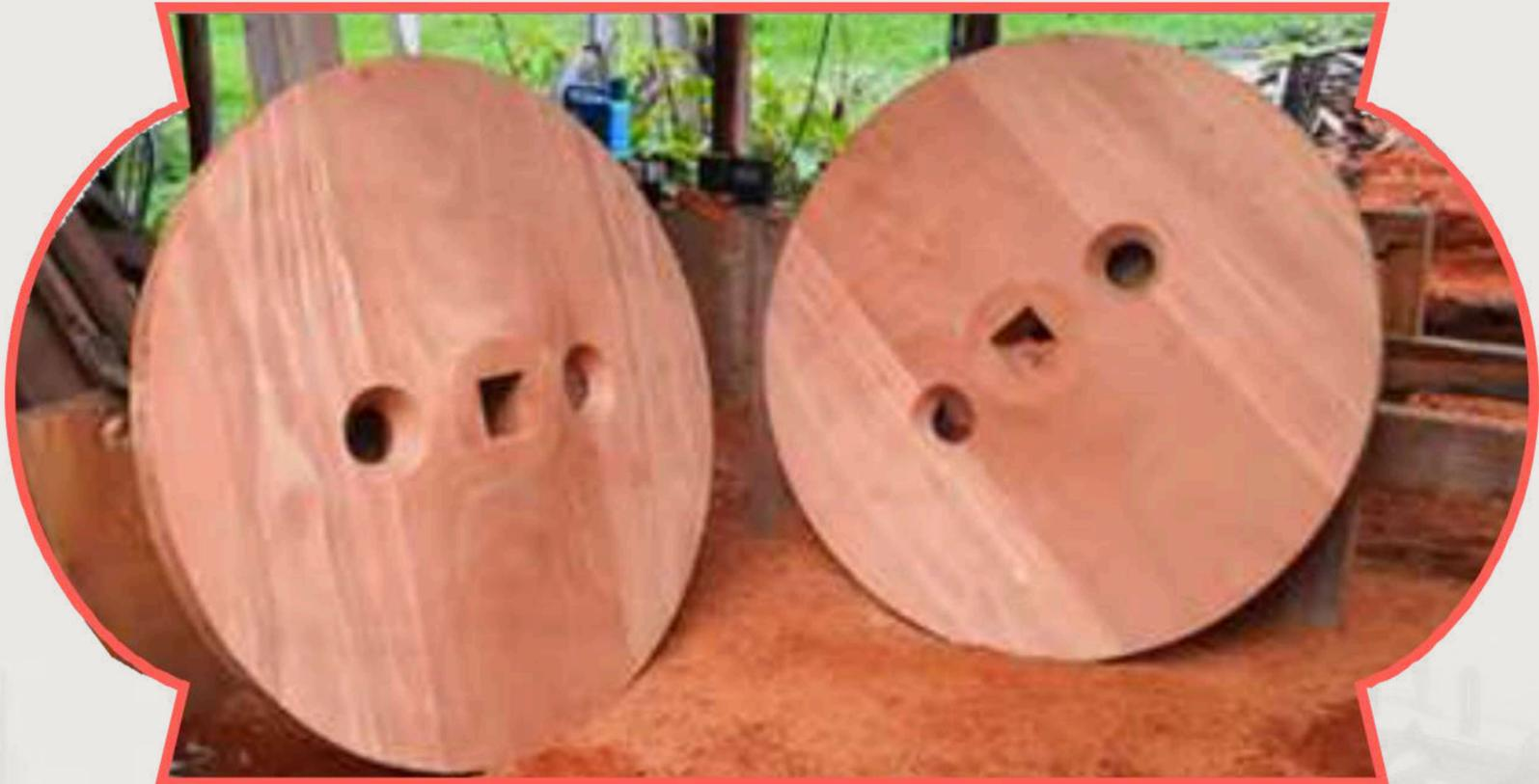
Cambotas e meião encaixados; ocas e mecha lapidadas. Lembrando que ao eixar as rodas, as ocas não ficam paralelas. Quando o carro andar a oca de uma roda fica na vertical e a outra na horizontal.
