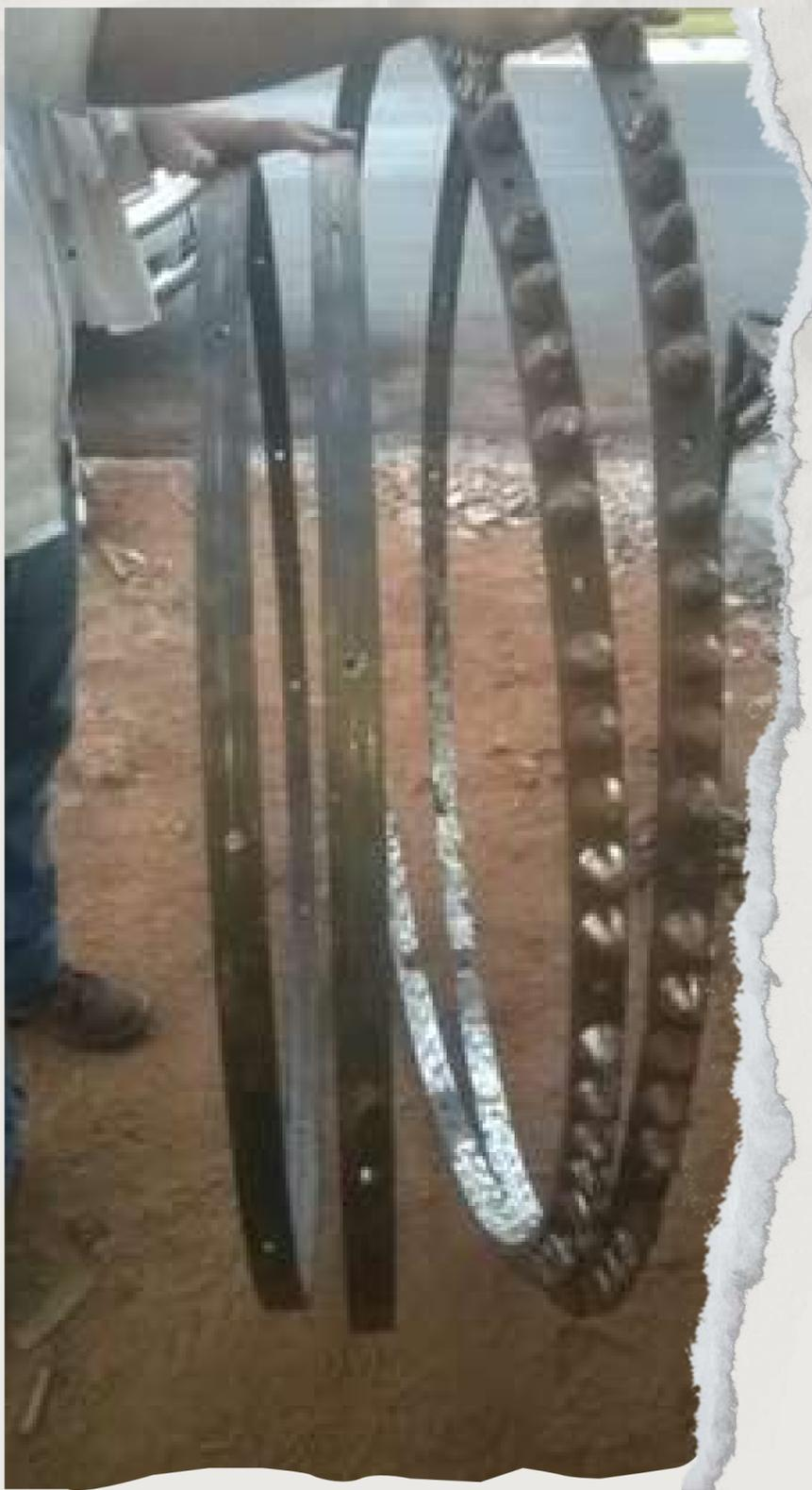
Etapa seguinte: cuidar das partes de ferro que compõem a roda. Chapa de ferro já calandrada. Podemos ver na foto inclusive uma com os cravos (pregos) em formato pião. A ferração da chapa requer agilidade e precisão, sempre realizada em conjunto. Processo de aquecimento da chapa para ferrar as rodas, por causa da alta temperatura a chapa irá dilatar. O momento exato em que a chapa ficar encandescente, ela está pronta para ser colocada em volta da roda.
