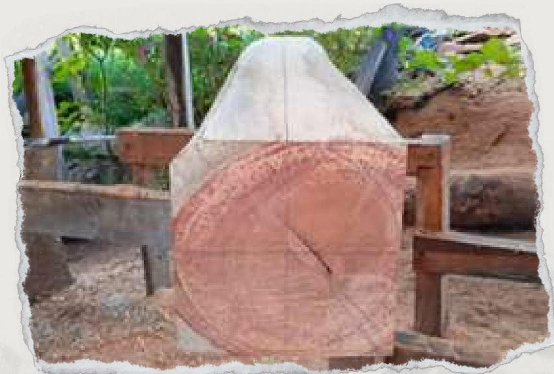
Tora de madeira preparada e com as riscas para a modelagem do eixo.
