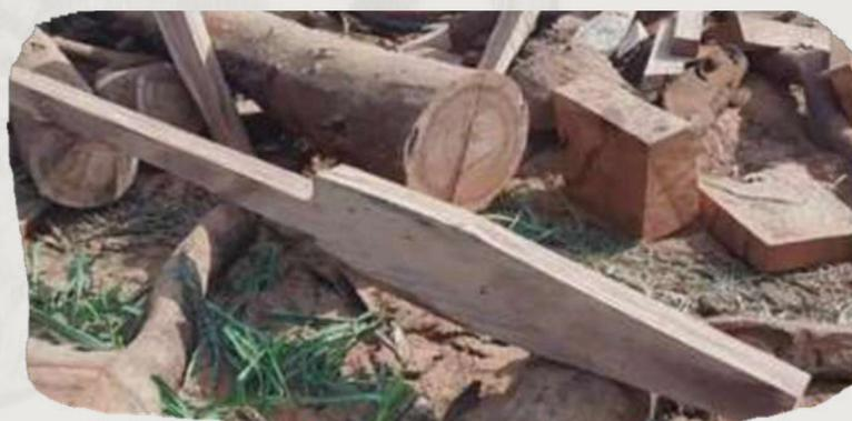
Na imagem acima observamos a extração de madeira de árvore morta. É possível visualizar brocas e ocos na madeira provocados por cupins e pela entrada de água da chuva no interior do caule. No centro da fotografia vemos uma prancha onde foi realizado o risco para o corte de um cabeçalho do carro de boi. É dessa forma que o carapina inicia o processo para o fabrico das peças do carro.
