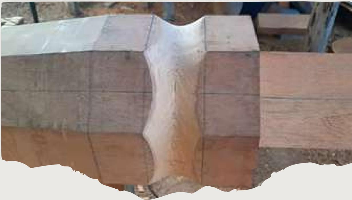
Eixo montado sobre a mesa com os chumaços e os cocões, peças que fazem o carro cantar.
