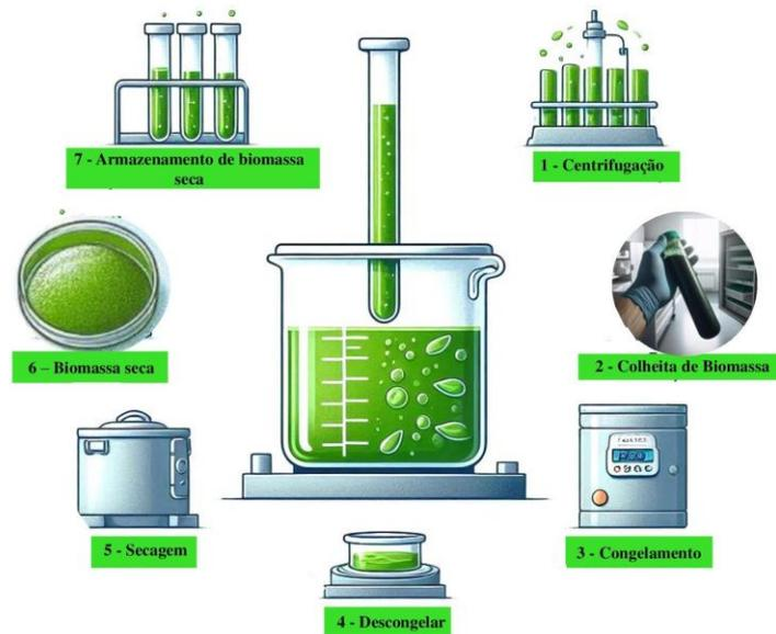
**Figura 3.** Ilustração esquemática do processo para obtenção de biomassa microalgal. 1 – Cultivo concentrado é centrifugado; 2 – Colheita da biomassa obtida pela centrifugação transferida para tubo falcon; 3 – Biomassa é congelada; 4 – Biomassa é descongelada em temperatura ambiente; 5 – Secagem de biomassa em estufa com circulação de ar; 6 – Biomassa seca; 7 – Biomassa seca armazenada. O fluxograma foi gerado com auxílio da ferramenta Bing Image Creator.
