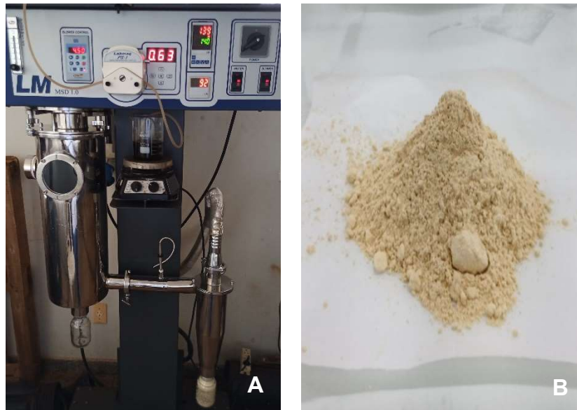
Figura 6 – Secagem por aspensão do extrato bruto concentrado com adição de adjuvantes. (A) Spray Dryer , (B) Extrato seco obtido
