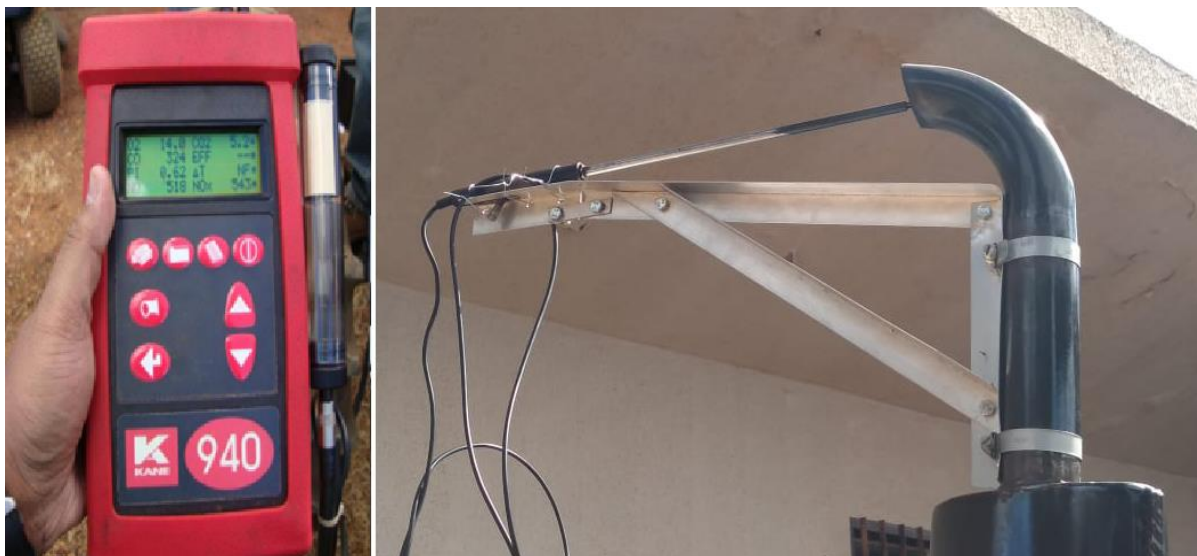
FIGURA 12. Monitor ambiental de combustão e emissão de gases utilizado no ensaio para determinar a temperatura de emissão dos gases de exaustão.
