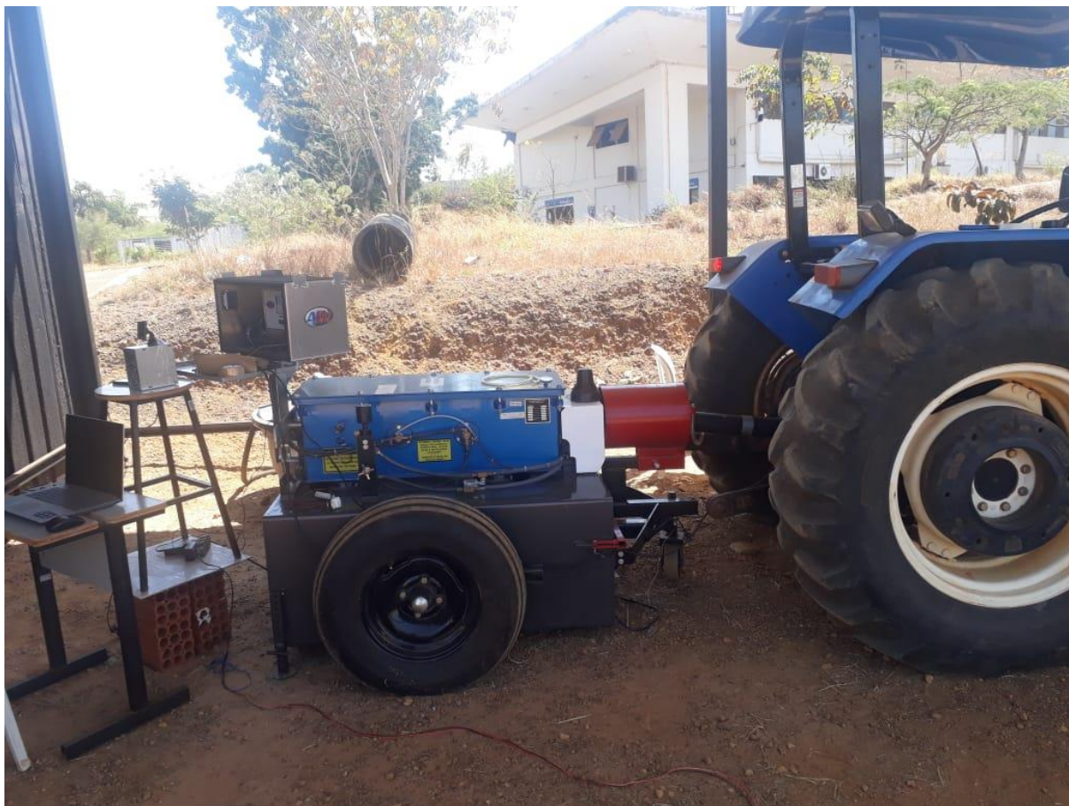
FIGURA 9. Conjunto trator/dinamômetro para o ensaio do motor de ciclo diesel. Fonte: Autor, 2019.
