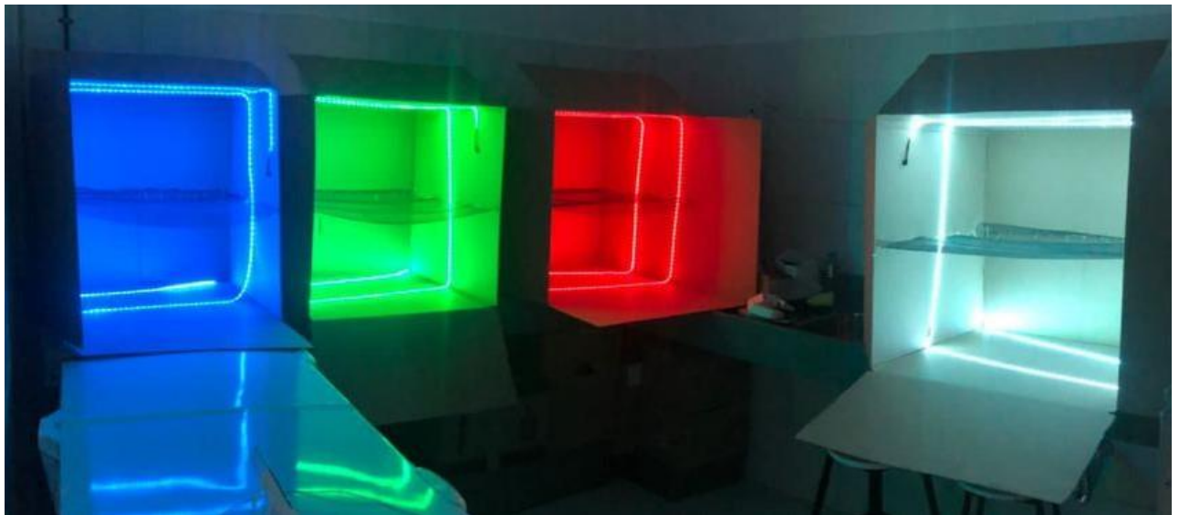
Figura 2 – Protótipos feitos de caixas de papelão ondulado (parede simples), tela plástica trefilada e fitas de lâmpadas LEDs montados
