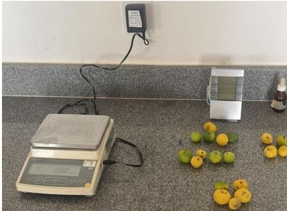
Figura 7 – Balança de precisão SHIMADZU modelo BL3200H, precisão de 0,01 g, utilizada para a realização da análise de perda de massa.
