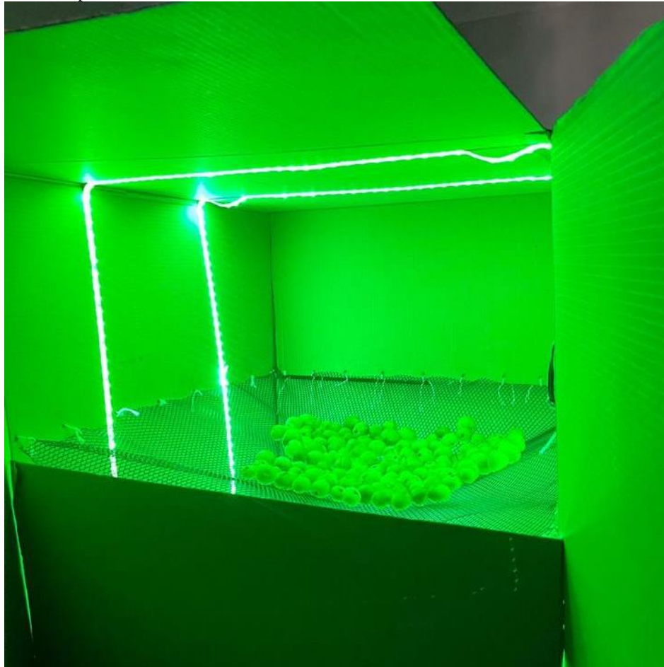
Figura 6 – Cagaitas posicionadas dentro dos protótipos feitos com caixa de papelão ondulado, tela plástica trefilada e fitas de lâmpadas de LED na luz LED verde
