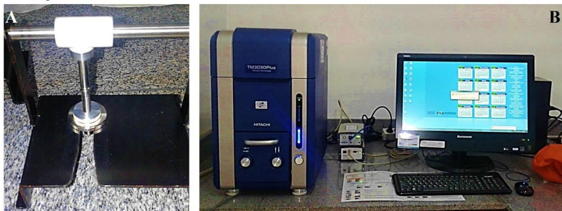
FIGURA 3 – Microscopia Eletrônica de Varredura: (A) Corpo de prova disposto no porta-amostras; (B) Microscópio eletrônico de varredura.
