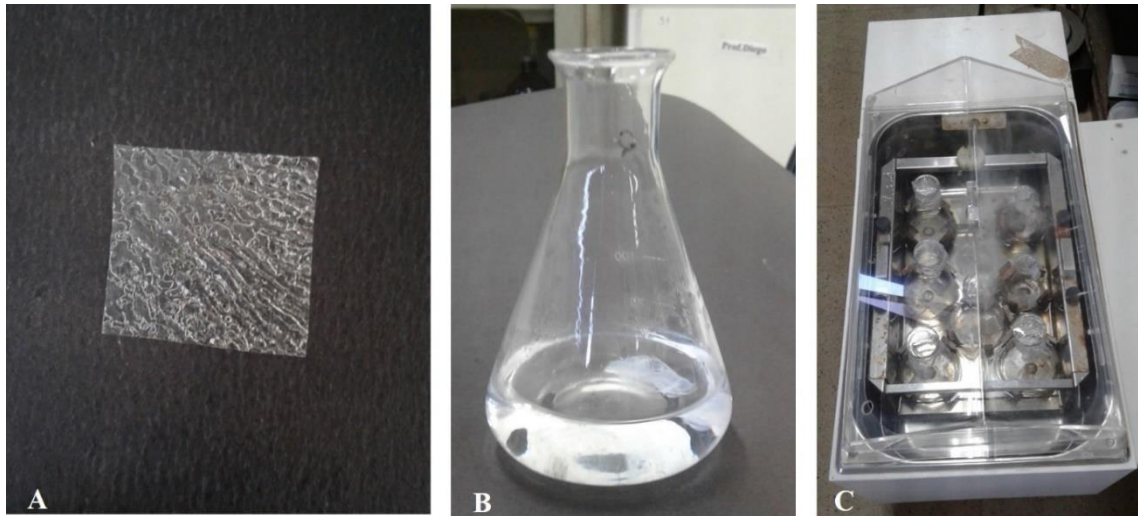
FIGURA 9 – Solubilidade: (A) Filme com 4cm 2 ; (B) Filme mergulhado no erlenmeyer com água destilada; (C) Banho Dubnoff.
