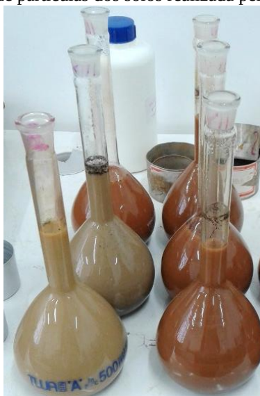
FIGURA 32 – Determinação da densidade de partículas dos solos realizada pelo método do picnômetro.
