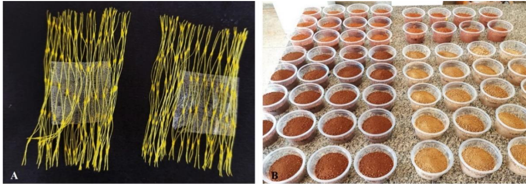
FIGURA 16 – Biodegradação: (A) Filmes colocados em redes de polietileno; (B) Filmes enterrados em diferentes solos.
