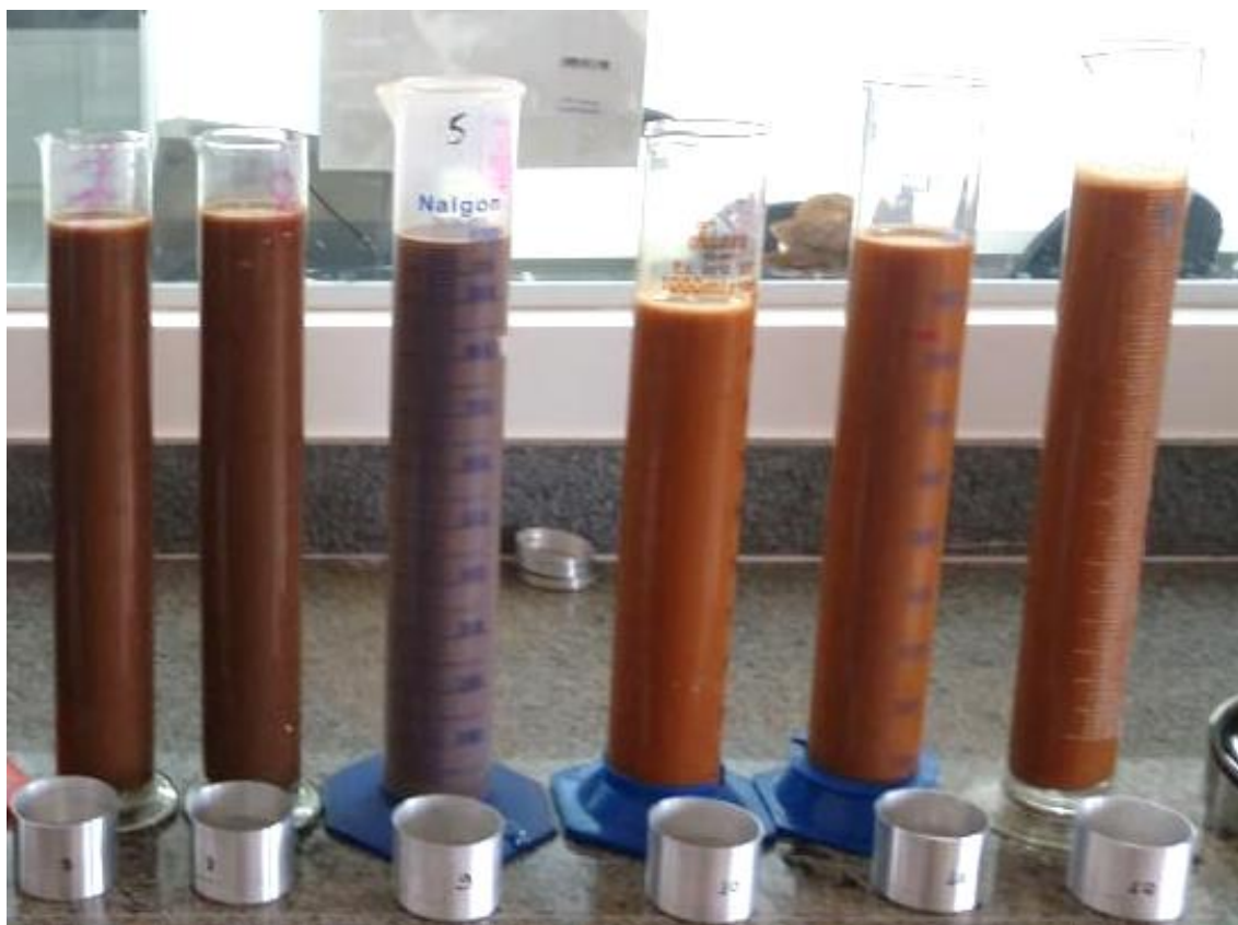
FIGURA 34 – Determinação da granulometria dos solos pelo método da pipeta.
