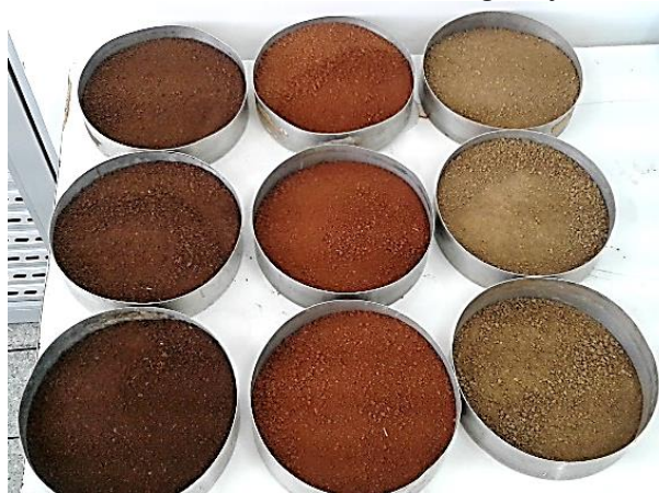
FIGURA 15 – Solos com diferentes texturas utilizados no ensaio de biodegradação.
