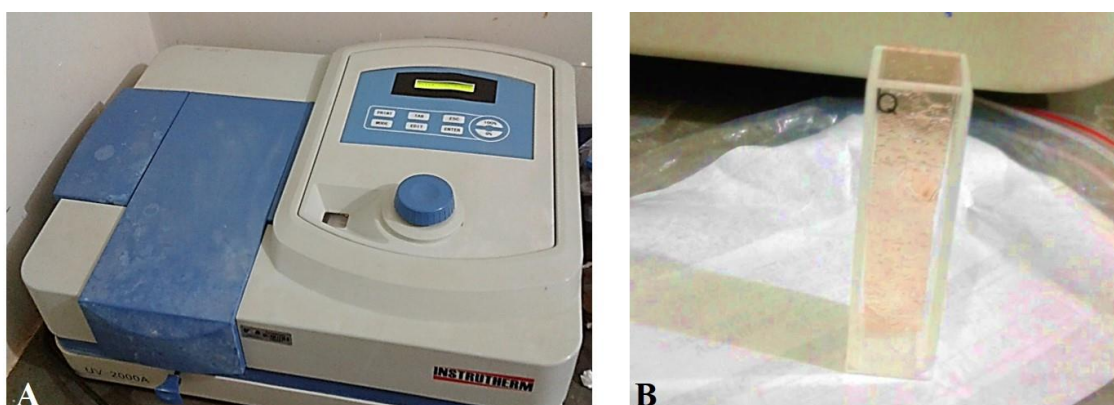
FIGURA 12 – Transparência: (A) Espectrofotômetro; (B) Filme inserido no interior da cubeta de quartzo.
