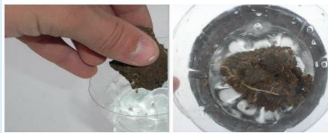
Figura 5. Procedimentos para observar o desprendimento do ar do solo na forma de bolhas.
