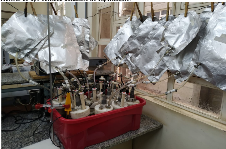
Figura 1. Sistema de reatores do tipo batelada utilizados no experimento.
