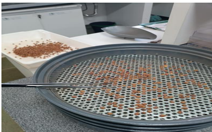
Figura 6. Jogo de peneiras utilizados para classificação de sementes de grão-de-bico em diferentes tamanhos. Fonte: Autor (2023)
