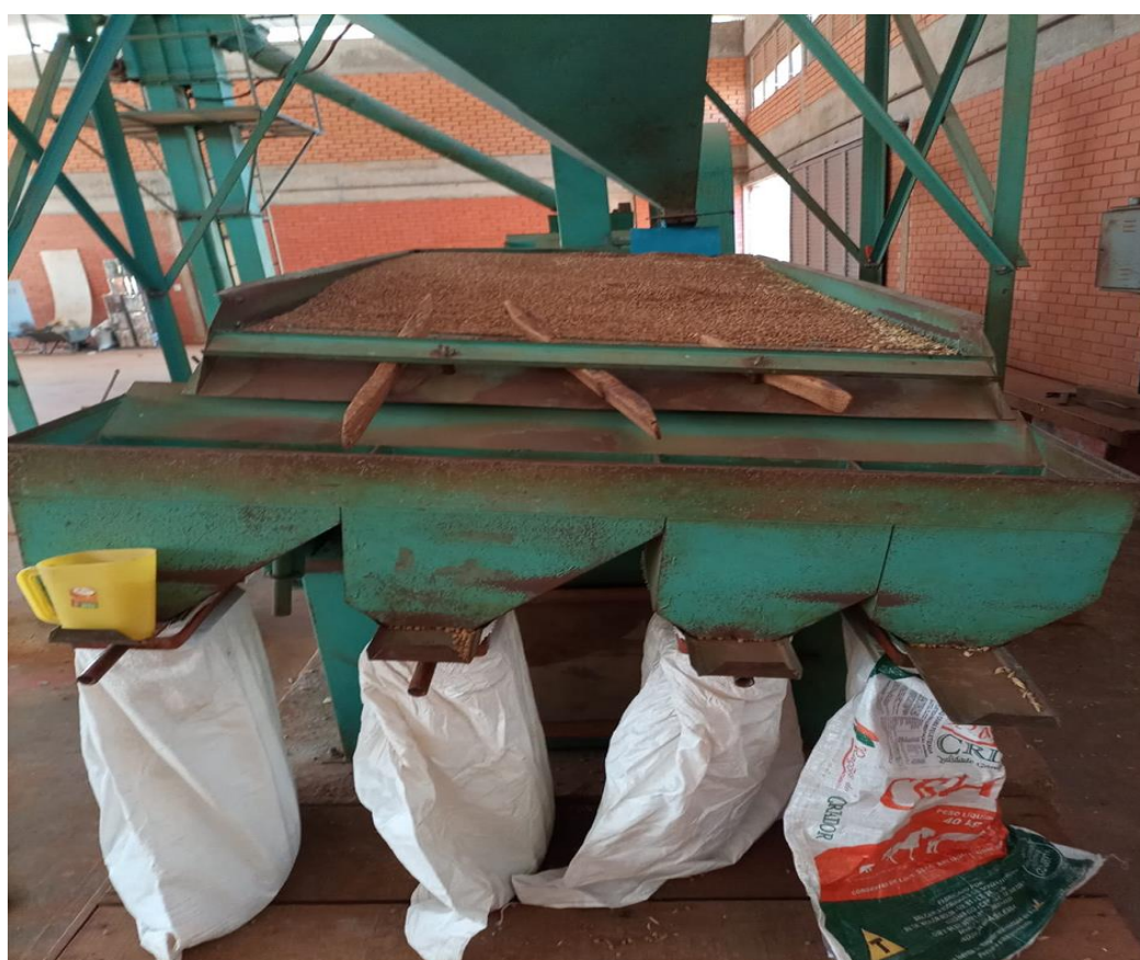
Figura 8. Mesa de gravidade Densimétrica. Fonte: Autor (2023)
