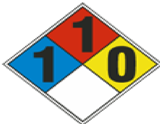
Figura 1.5 - O "diamante do perigo" ou "diagrama de Hommel" como definido pela NFPA 704.
