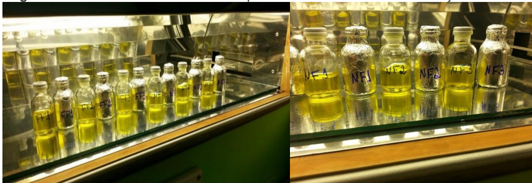
Figura 12 – Amostras de óleo de baru expostas a luz no teste de foto-oxidação acelerada.
