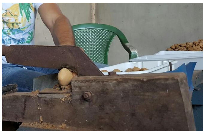
Figura 10 – Equipamento utilizado para a retirada das amêndoas do interior dos frutos de baru com um sistema de foice
