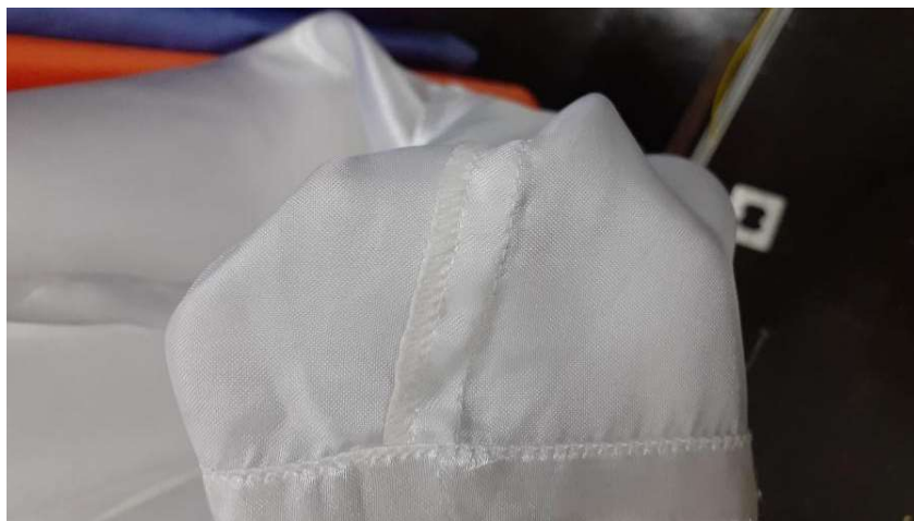
Figura 32 - Acabamento da veste confeccionada pelo alfaiate Adalto Domingues - Feito em maquinário do tipo Interlock
