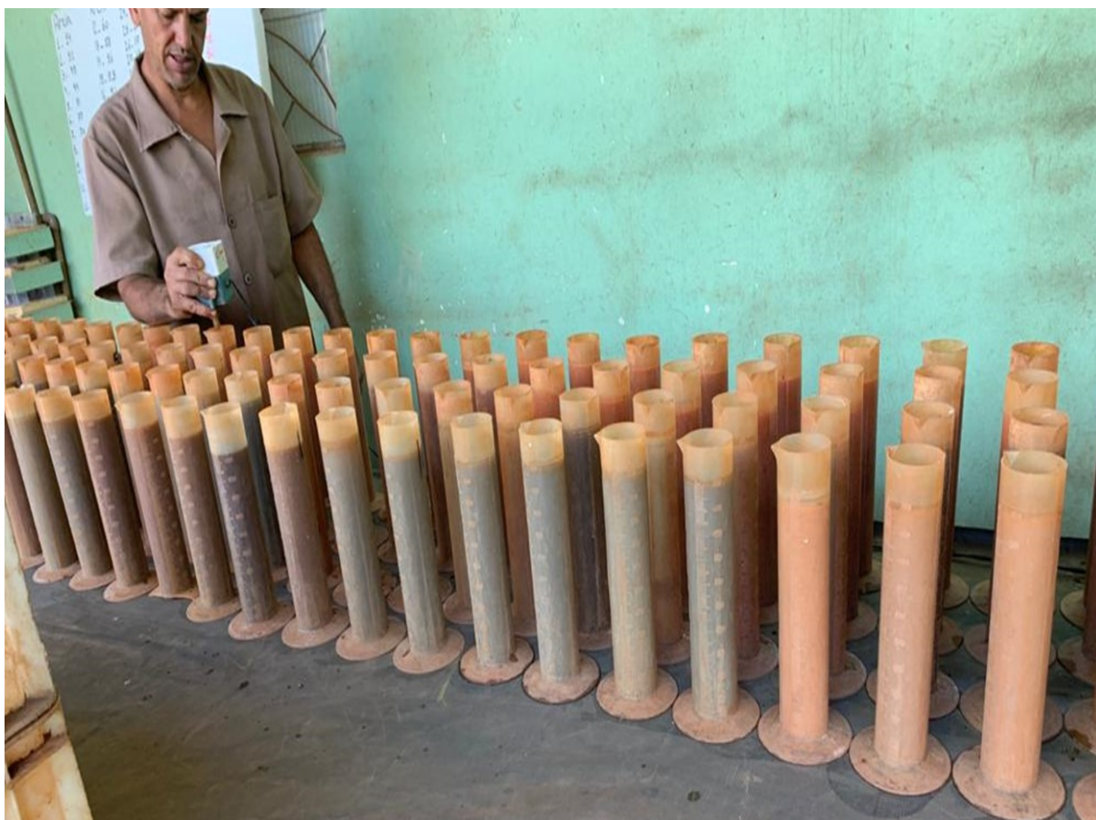
FIGURA 10. Amostras de solo sendo agitadas por agitador mecânico de hélice
