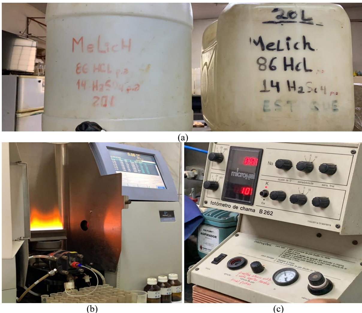
FIGURA 15. Solução extratora Mehlich (a); Espectrofotômetro de absorção atômica (b); Fotômetro de chama (c).
