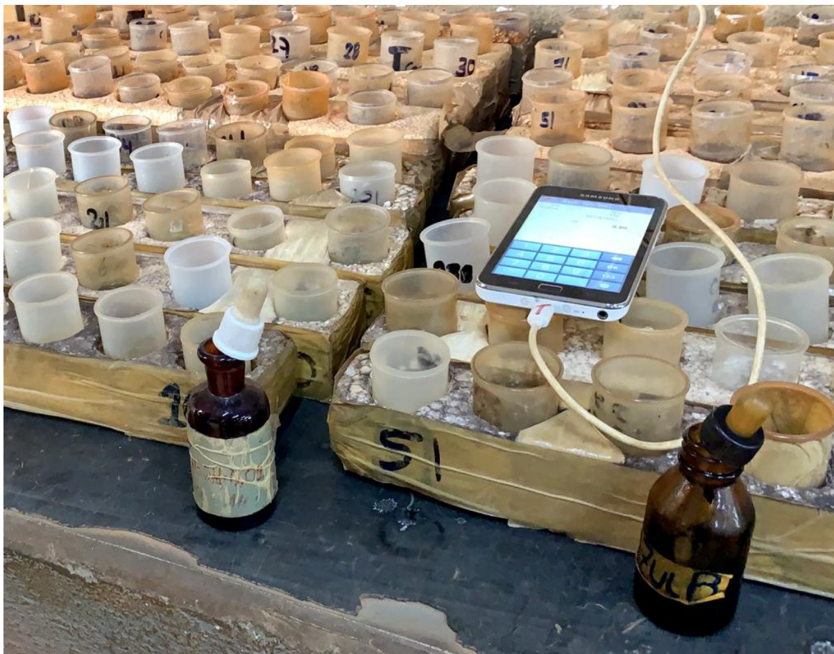
FIGURA 13. Aplicação das gotas de azul de bromotimol para leitura do alumínio trocável.
