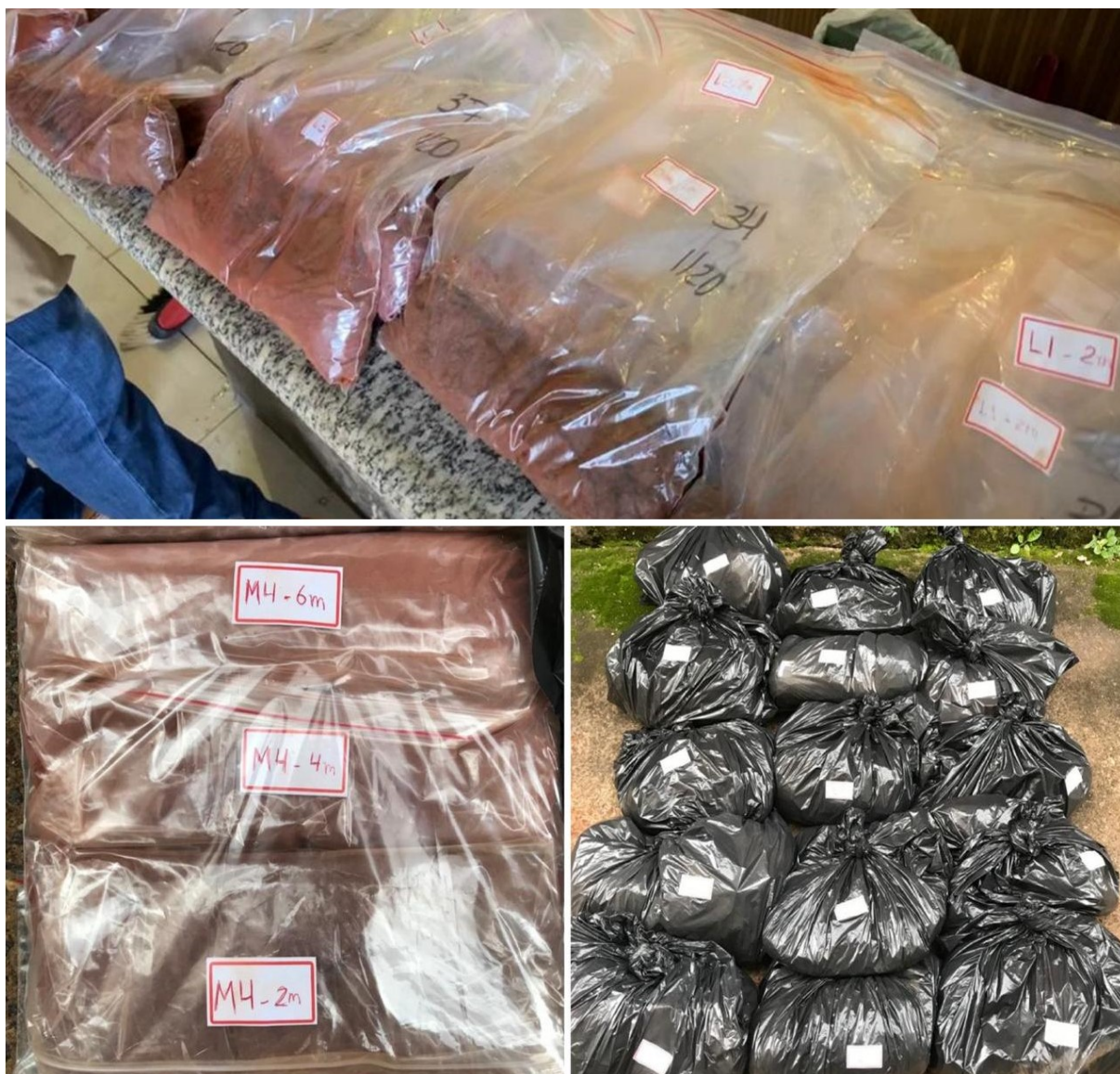
FIGURA 9. Amostras de solo etiquetadas e embaladas em sacos de plásticos (zip lock)
