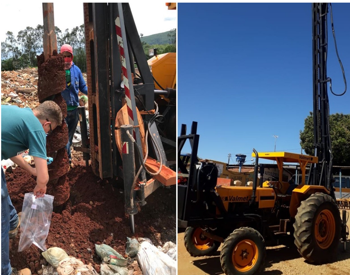
FIGURA 8. Trado Mecânico acoplado em trator para coleta de amostras simples a profundidades até seis metros.
