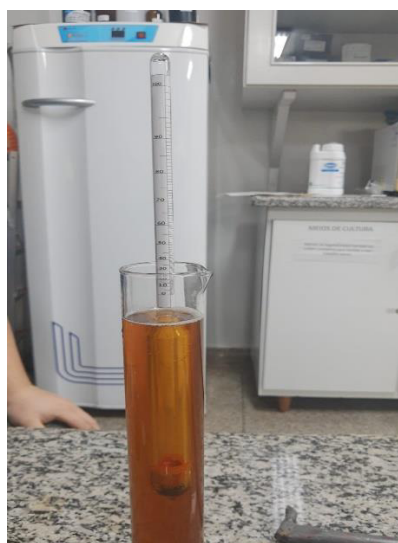
FIGURA 4 - Avaliação do teor alcoólico da kombucha, utilizando o alcoômetro centesimal (Alcoômetro Gay Lussac), da marca Incoterm®.
