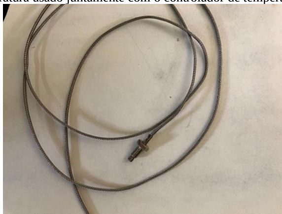
Figura 14 - Sensor de temperatura usado juntamente com o controlador de temperatura.
