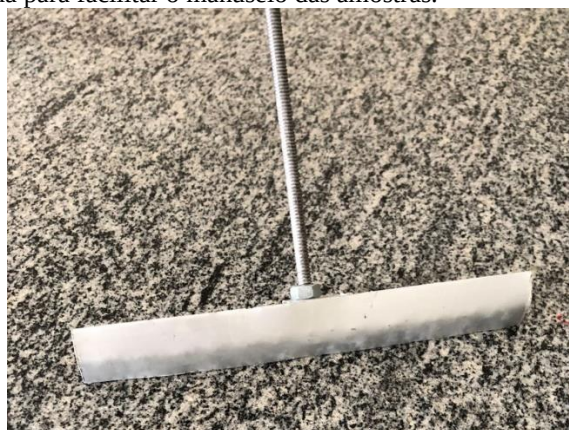
Figura 19 - Pá giratória usada para facilitar o manuseio das amostras.
