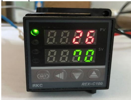
Figura 13 - Controlador de temperatura tipo PID.
